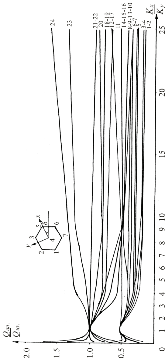
Рис. 5.10. Зависимость отношения \frac{Q_{ан.}}{Q_{из.}} от \frac{k_x}{k_y} при семиточечной системе расстановки скважин.
